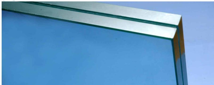
Триплекс – это многослойное ламинированное стекло, состоящее из двух и более стёкол, склеенных между собой специальной полимерной плёнкой. Технология изготовления триплекса напоминает процесс ламирования, поэтому триплекс зачастую называют ламинированным стеклом.
