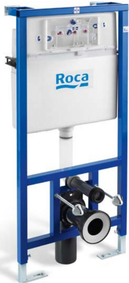
Инсталляционная система позволяет легко и надежно монтировать подвесные унитазы. Бачок инсталляционной системы оборудован двухрежимным сливным механизмом (6/3 литра). В комплект включены все необходимые крепления и патрубки.
