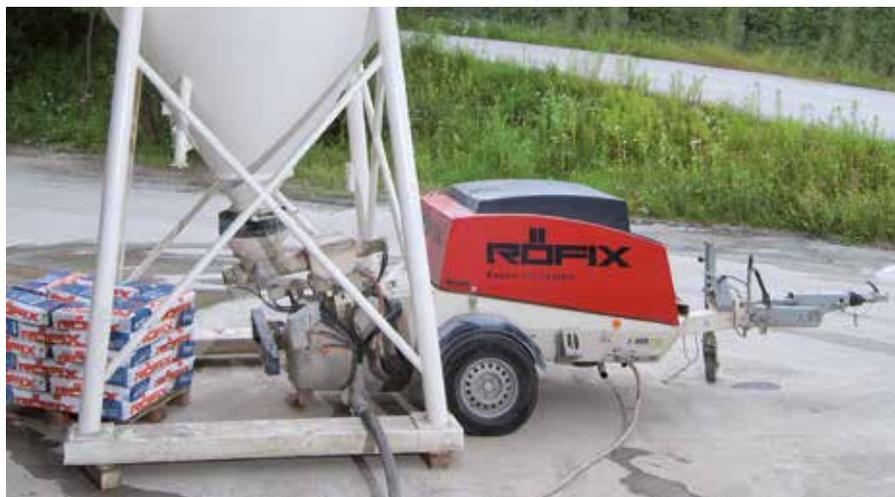
La malta miscelata con acqua va posta in opera con una pompa per massetti o manualmente sul supporto adeguatamente predisposto.
