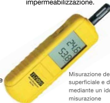
Misurazione della temperatura superficiale e dell'umidità dell'aria mediante un idoneo strumento di misurazione
