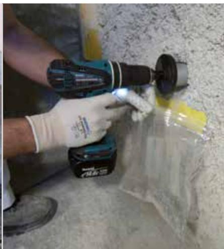
Prova dell'intonaco a contenuto salino
