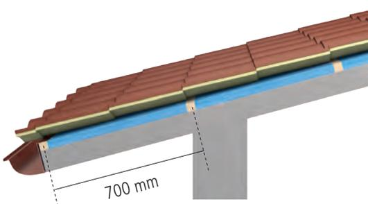
In caso di isolante rigido: appoggi ogni 700 mm
