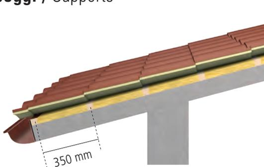
In caso di isolante flessibile: appoggi ogni 350 mm
