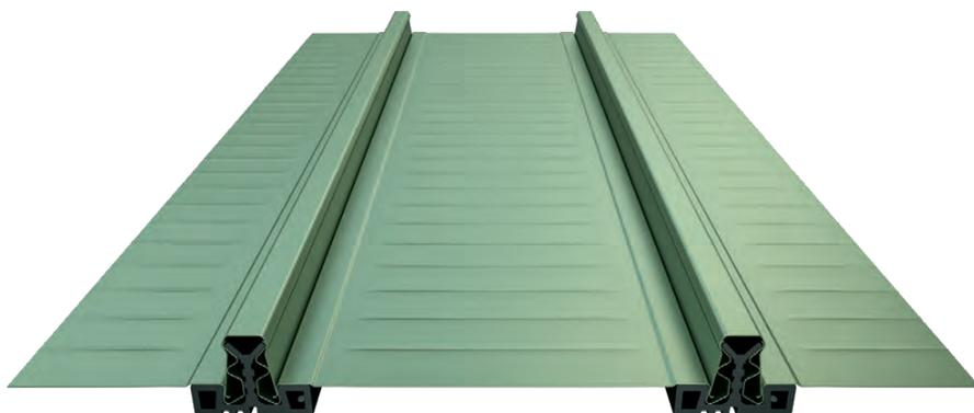
Alugraf è un sistema di copertura metallica costituito da 3 elementi: lastra, cappello e staffa. E' un sistema di copertura a doppio effetto drenante: la particolare conformazione del giunto drenante a labirinto permette la protezione totale anche in caso di basse pendenze e eventi atmosferici eccezionali.
