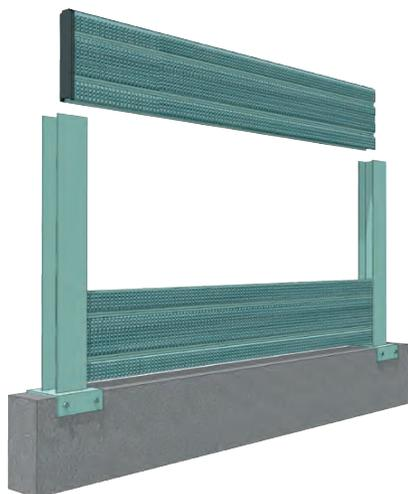
Facile inserimento del pannello in montanti tipo HE 140-160-180 fissati alla fondazione di base attraverso delle piastre imbullonate a tirafondi annegati nel cemento armato.
