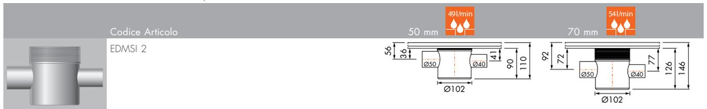
Scarico verticale 50 mm. Viene fornita con sifone antiodore di 70 mm.
