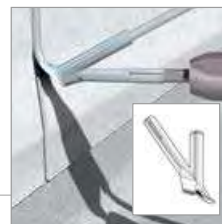
Saldatura alla parete con cordolo CR41 - H231
