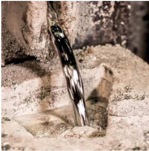
Fusione dello zinco con gli elementi di lega (rame e titanio).
