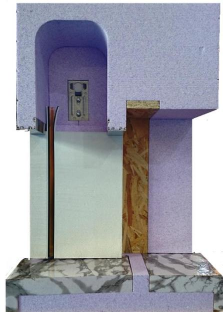
**Spalle autoportanti** spessore cm 9.5, composte da OSB accoppiato con EPS idrorepellente ad alta densità (35 kg/mc), rasate con rete in fibra di vetro e resina cementizia effetto intonaco pronte per essere tinteggiate, con annegate all'interno apposite guide in alluminio per lo scorrimento dell'avvolgibile e paraspigolo in PVC con rete premontato sulla spalla atto a collegarsi con la rete del cappotto o intonaco per garantire l'eliminazione di giunti e movimenti strutturali.
