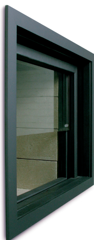
Profilo su 4 lati e controprofilo laccato colore antracite per mascherare gli angoli della struttura esterna intorno all'antina conferendogli un effetto cornice. Esiste anche nella versione su 3 lati per monoblocchi posizionati a raso terra.
