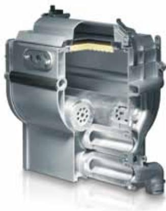
Lo scambiatore di calore brevettato da Buderus utilizza le innovative tecnologie TFT (tubi a flusso elicoidale), che migliora lo scambio termico grazie alla turbolenza del flusso d'acqua e permette dimensioni ridotte dello scambiatore, e ALU plus, che semplifica la manutenzione grazie alle superfici di scambio termico autopulenti.
