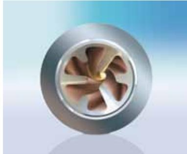
Lo scambiatore di calore utilizza la tecnologia TFT: i tubi a flusso elicoidale di concezione innovativa migliorano lo scambio termico grazie alla turbolenza del flusso d'acqua. La struttura della tecnologia TFT permette, inoltre, dimensioni ridotte dello scambiatore di calore: i canali interni ai tubi alettati torniti uno nell'altro creano un'ampia superficie per la trasmissione di calore e le alette dei tubi alettati sono alte solo 15mm.
