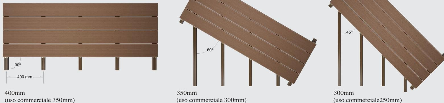
**Qualora il pavimento sia destinato ad un uso intensivo/commerciale e/o di piani sopraelevati (caso nel quale è assolutamente necessario sostituire i profili di supporto standard con i profili di supporto strutturali), lo spazio tra i profili dovrà essere ridotto** seguendo le indicazioni della figura 5.
