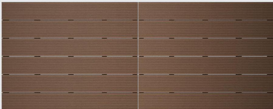
La prima opzione garantisce una posa uniforme e equilibrata del sistema, che permette di sfruttare l'intera lunghezza delle doghe, indipendentemente dalle dimensioni del pavimento.
