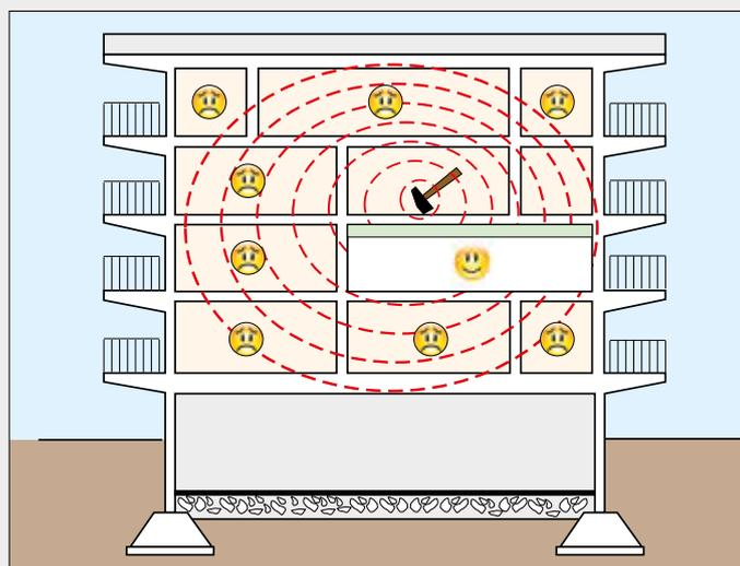
Con il PAVIMENTO GALLEGGIANTE non si trasmette la vibrazione e isola tutto l'edificio
