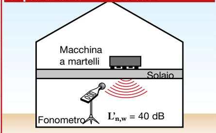
L'indice del livello del rumore misurato in opera, come richiesto dalla legge, si esprime con il simbolo  $L_{n,w}$  e si misura in dB lineari, rappresenta il rumore trasmesso per via diretta e per via indiretta che si misura nell'ambiente ricevente.
