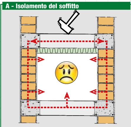
Spesso va associata all'isolamento delle pareti (B) rivestite con la stessa tecnica, altrimenti le trasmissioni laterali del rumore di calpestio sarebbero così importanti da vanificare l'isolamento del solo soffitto. Essendo una tipologia di intervento invasiva che riduce lo spazio abitabile, viene riservata ad alcuni locali dell'unità abitati-
