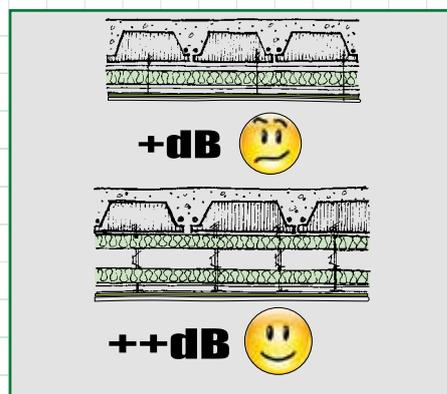
L'inserimento fra le due lastre della lamina TOPSILENTBitex migliorerà ulteriormente la prestazione acustica, oppure in alternativa può essere usata TOPSILENTGips, la lastra preaccoppiata a TOPSILENTBitex, che riduce le operazioni di posa e la cui facilità di posa in opera meglio si apprezza nella posa in controsoffitto.
