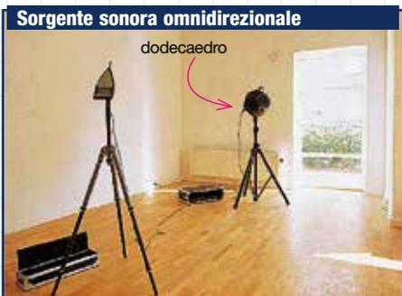
Si noti che rispetto alla prova del calpestio in questo caso si misura con due fonometri una differenza di livello per cui contrariamente al caso suddetto **più elevato è l'isolamento del divisorio più elevata sarà la differenza del rumore fra le due stanze e quindi più alto il potere fonoisolante di questo.**
