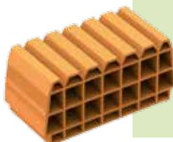
Il **LATERIZIO PER SOLAI** offre soluzioni per **soddisfare qualsiasi esigenza di progettazione**: con l'accostamento di più laterizi si possono realizzare **solai a nervature parallele**, ma possono anche essere utilizzati in abbinamento a tutti i tipi di travetti (tralicci, con fondello o precompressi), nonché su lastre in calcestruzzo, normale o precompresso.
