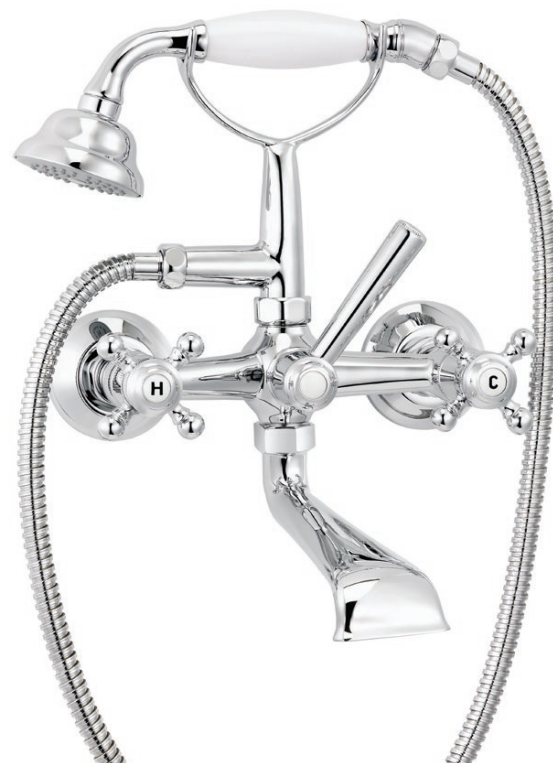
Mélangeur bain-douche mural avec flexible, grande douchette et fourche haute Bad-douche mengkraan voor wandmontage met slang, grote handdouchette en hoge vork Wall-mounted bath and shower mixer with flexible, great handshower and high fork ref. 1921.--.99 bec - uitloop - spout 210 mm from wall ref. 1921.--.69 bec - uitloop - spout 140 mm from wall (not illustrated)
