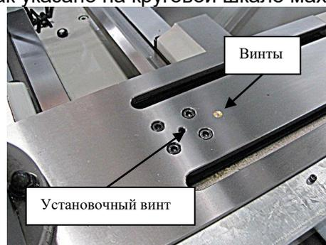
Рис. 81. Регулировка люфта поперечной подачи, установочным винтом.
