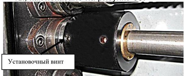
Рис. 89. Удаление установочного винта из ободка муфты.
