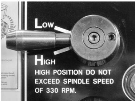
Рис.15. Рукоятка переключения диапазонов передней бабки.
