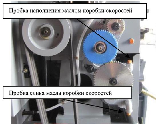
Рис. 69. Расположение пробок наполнения и слива коробки скоростей.
