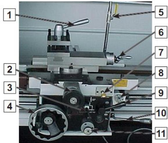
Рис.4. Элементы управления суппортом.
