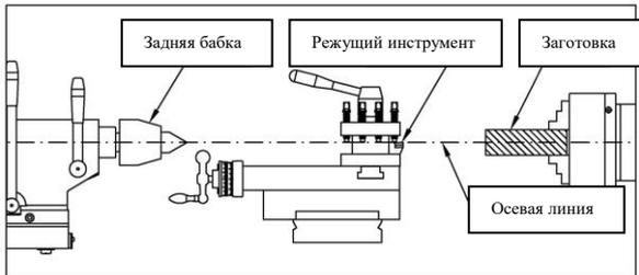
Рис. 40. Режущий инструмент выровнен по центру заготовки.
