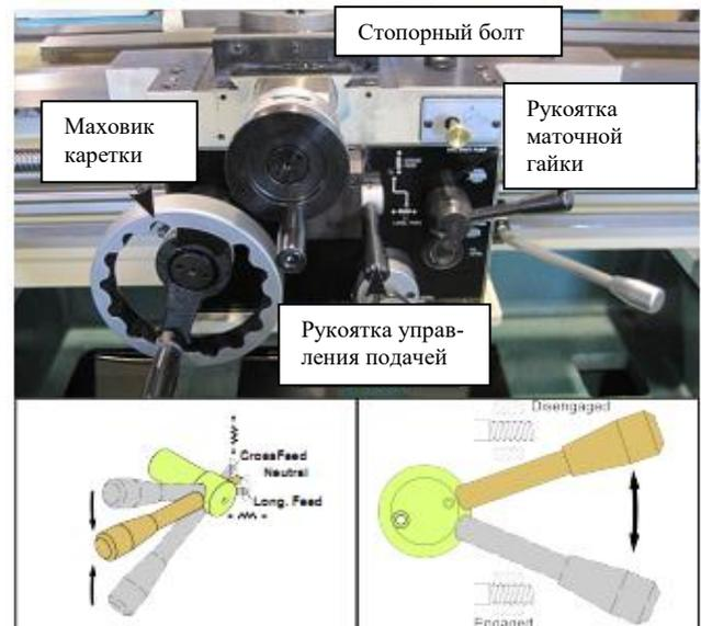
Рис.9. Механизмы управления перемещением каретки.
