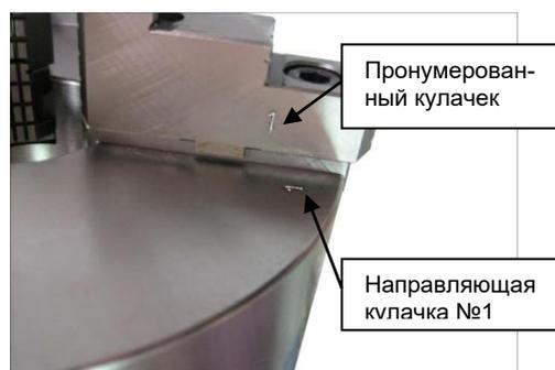
Рис. 28. Кулачковые направляющие и пронумерованный кулачек.
