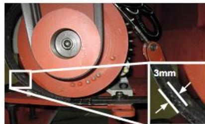
Рис. 93. Минимальная толщина ремennой прокладки тормоза
