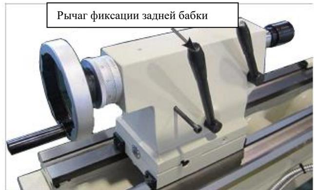
Рис. 8. Рычаг фиксации задней бабки.
