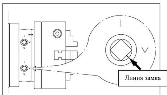
Рис. 7. Эксцентрик и линии.
