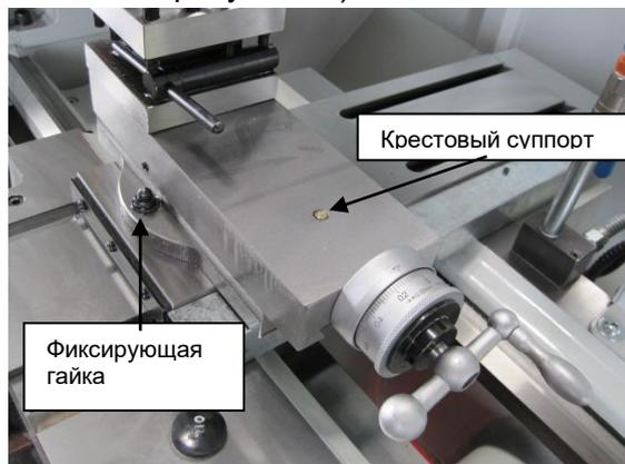
Рис. 38. Установка крестового суппорта под углом.
