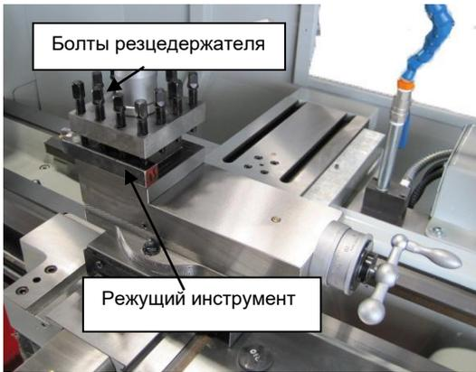
Рис. 39. 4-х позиционный резцедержатель.
