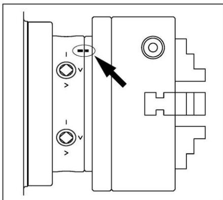
Рис. 26. Патрон выровнен по установочным меткам.
