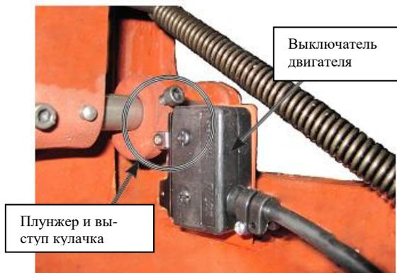
Рис. 96. Выключатель двигателя.
