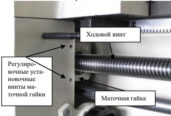
Рис. 87. Регулировка клина маточной гайки.
