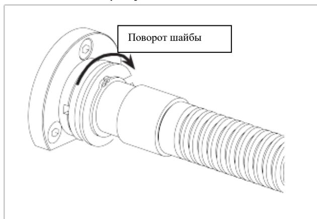
Рис. 101. Позиционирование шайбы.
