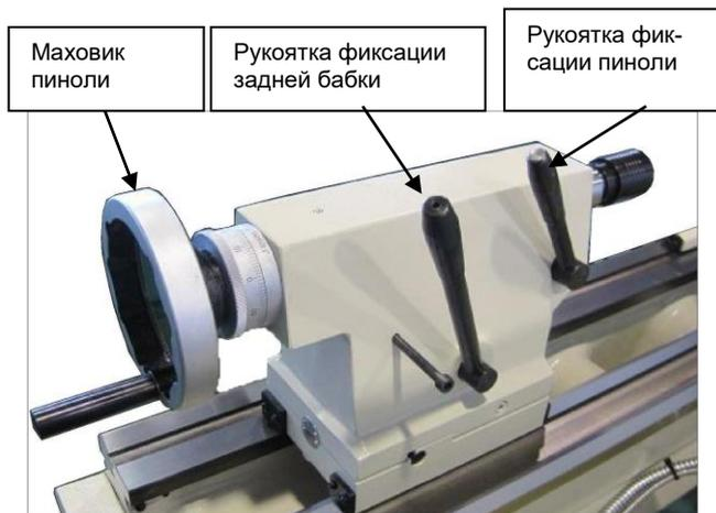
Рис. 31 Рукоятки фиксации задней бабки и пиноли в положении зажима.
