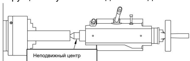
Рисунок 34. Пример использования неподвижного центра в задней бабке
