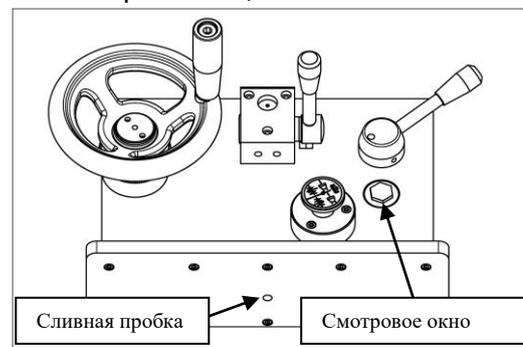
Рис. 70. Расположение сливной пробки салазок и смотрового окна.
