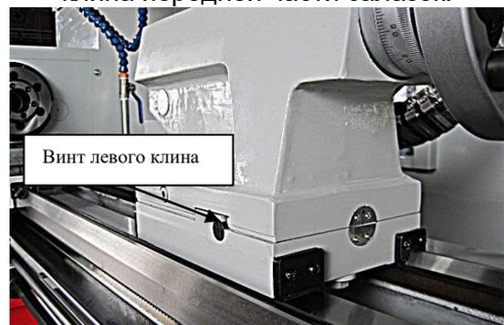
Рис. 86. Один из двух винтов клина задней бабки.
