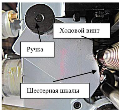
Рис. 53. Шкала резьбы в зацеплении с ходовым винтом.
