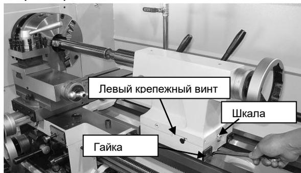
Рис. 32. Регулировка смещения задней бабки.
