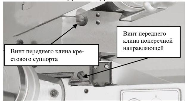
Рис. 83. Винты передних клиньев крестового суппорта и поперечных направляющих
