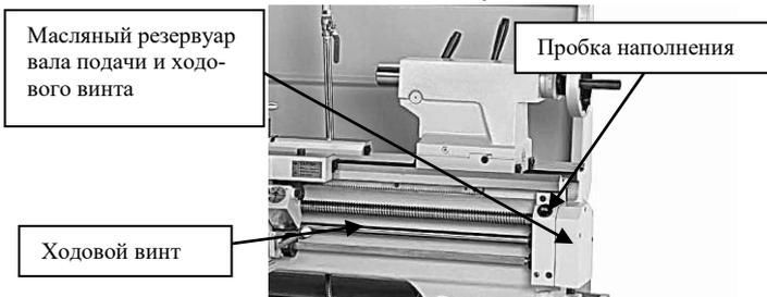
Рис. 72. Смазка ходового винта
