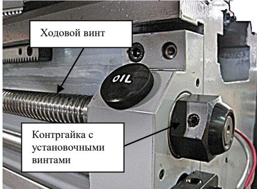
Рис. 82. Регулировка люфта ходового винта
