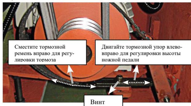
Рис. 94. Регулировка тормозной передачи.
