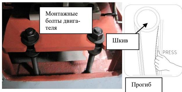
Рис. 92. Регулировка зубчатого ремня.
