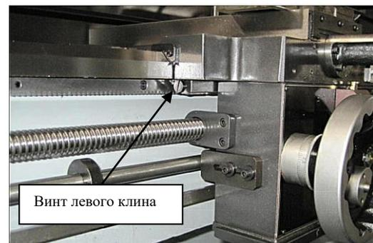
Рис. 85. Один из двух винтов клина передней части салазок.
