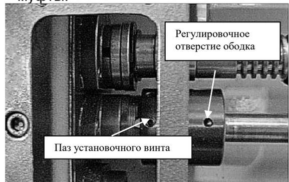
Рис. 90. Выравнивание установочного винта муфты подачи.
