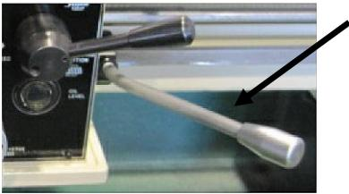
Рис. 20. Рукоятка Вкл./Выкл. шпинделя.
