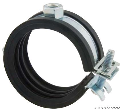
Хомут BISMAT® Flash имеет современную систему быстрого замка. Хомут закрывается простым нажатием пальца на запирающий винт. Не требуется ручной инструмент.
