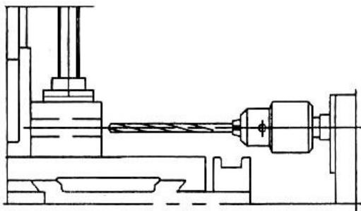
Снять опоры для квадратного долбяка, отрегулировать высоту стола для долбления пазов. Установить направляющую плиту в вертикальное,
