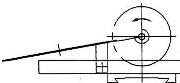
Установите специальную опорную плиту для заточки пилы и прикрутите ее болтами. Установите стол для долбления пазов на такую высоту и в таком горизонтальном положении, чтобы выступающая линия зубьев пилы проходила приблизительно через центр точильного круга. Необходимо
