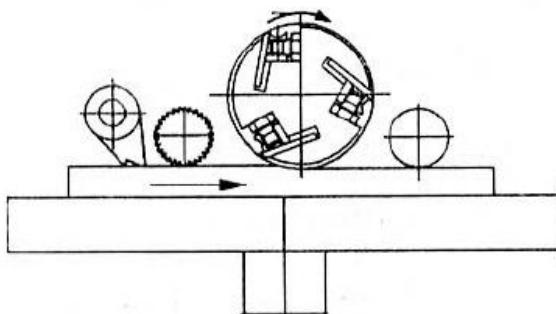
Глубина при пресс-строгании должна часто проверяться по фактическому размеру обработанной заготовки. Перед введением сменной шестерни в зацепление потянуть на себя клиновой ремень, провернуть рукоятку с тем, чтобы зубчатые колеса вошли в зацепление при движении. Точная глубина строгания определяется в зависимости от качества и ширины деревянной заготовки, подлежащей обработке. Если заготовка относительно тяжелая,
