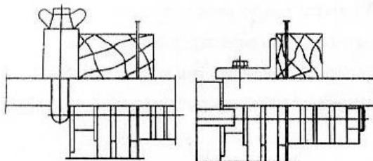
Разделяющий инструмент следует сравнивать с дисковой пилой. Кожух дисковой пилы расположить так, как того требует толщина заготовки. В общем случае рекомендуется поднять верстачный рубанок дисковой пилы на высоту 0,5-1мм над задней плитой. Для лучшего качества пиления
