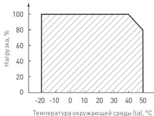
Рисунок 2. Максимальная допустимая нагрузка, % от мощности источника.
