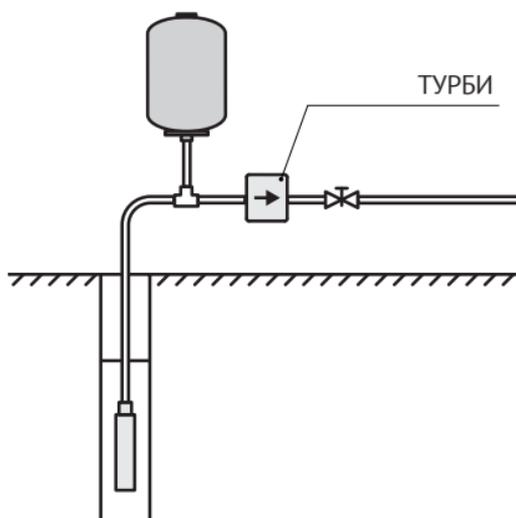
Рисунок 5 - Вариант установки Блока с погружным насосом
