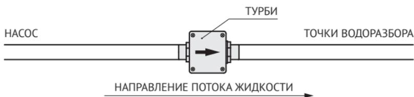
Рисунок 2 – Установка Блока на напорной магистрали
