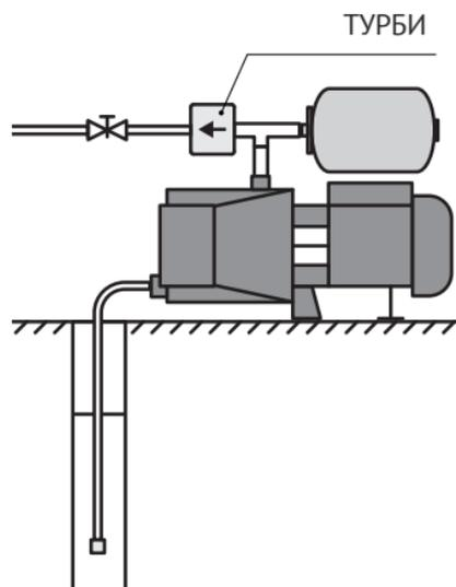
Рисунок 4 - Вариант установки Блока с поверхностным насосом
