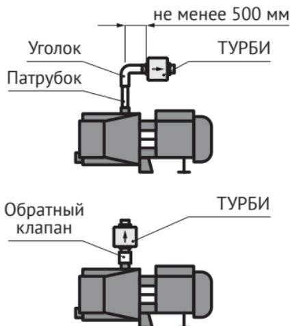
Рисунок 3 - Варианты установки ТУРБИ на поверхностный насос
