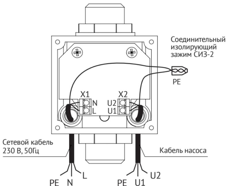
Рисунок 6 - Электрическая схема подключения
