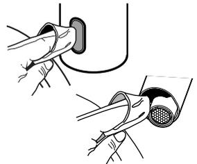
**ES** Limpiar el grifo solo con detergentes líquidos no ácidos. No utilizar ningún tipo de estropajo. Mantener limpio el visor cuidando de no rayarlo.
