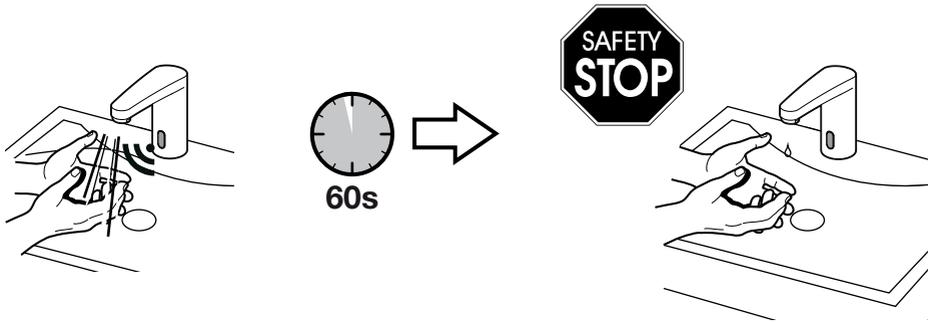
**ES** El flujo de agua se interrumpirá automáticamente pasados 60 segundos de su activación, como medida de seguridad, ante la invasión prolongada del campo de detección por parte de algún objeto. El grifo volverá a quedar operativo al retirar el objeto causante de la activación.
