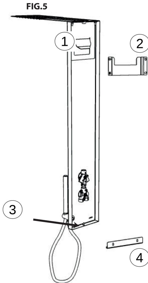
**ITA** - Dopo aver correttamente posizionato la colonna sulle rispettive staffe di supporto e bloccaggio, avvitare la vite anti-estrazione (1) come indicato in Fig. 6.
