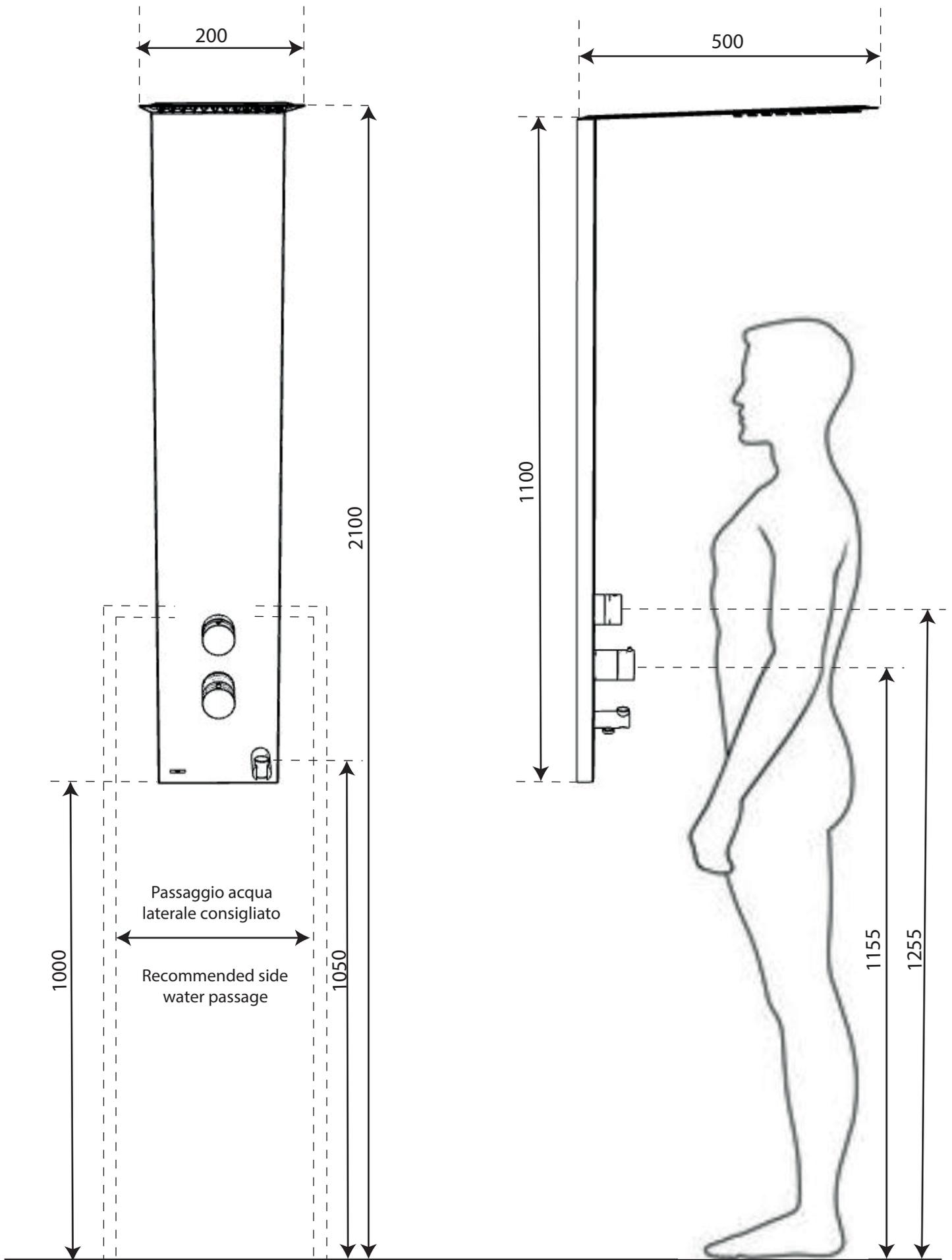
**ITA** - Per una corretta installazione della colonna doccia fare riferimento alle quote indicate in Fig. 2 per predisporre i tasselli di ancoraggio delle staffe di supporto alla colonna doccia. Le misure indicate si riferiscono ad un'altezza da terra consigliata del soffione doccia pari a 2.100 mm.
