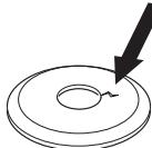
Проверьте, чтобы контргайка не потеряла своего усилия. Фиксирующее усилие гайки должно быть как минимум 1,5 Нм. Гайку следует затягивать с усилием в 35-50 Нм.
