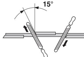
Отрегулируйте разводку. Она должен составлять 1 мм.
