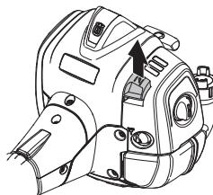
Достать воздушный фильтр, сняв крышку цилиндра. Промыть в чистой, теплой мыльной воде. Очистите крышку фильтра изнутри с помощью сжатого воздуха или щетки. Перед сборкой удостовериться, что фильтр сухой.
