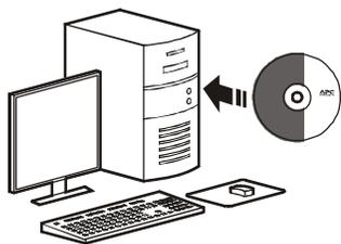
Программное обеспечение APC PowerChute Personal Edition позволяет автоматически сохранять файлы и выключать компьютер в случае сбоя подачи питания. Используйте кабель, поставляемый с устройством Back-UPS, чтобы подключить порт передачи данных на Back-UPS к USB-порту компьютера. Вставьте компакт-диск в устройство чтения компакт-дисков компьютера и следуйте инструкциям на экране.
