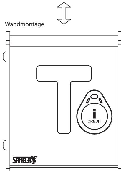
Drähte im Schrank müssen min. 40 cm lang (von der Wand). Vor der Installation entfernen Sie die äußere Kabelisolierung für eine einfache Handhabung im Schrank. (siehe Baubereitschaft)
